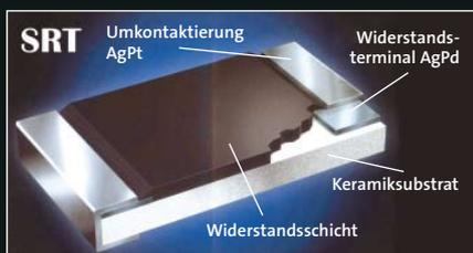
Bild 2: Für Hochtemperatur geeigneter Widerstand mit PtAg-Terminierung.
